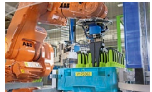
Der kleinere der beiden Mehrachsroboter entnimmt die fertigen Messer samt Scheiden aus den Trays, um sie direkt im Verkaufsdisplay zu platzieren.
