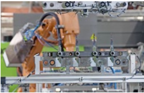
Mit dem Platzieren der Klingen auf der Trägerleiste startet der Fertigungszyklus. Jeweils vier Klingen entnimmt der größere der beiden Mehrachsroboter aus dem Magazin. Fotos: Engel
