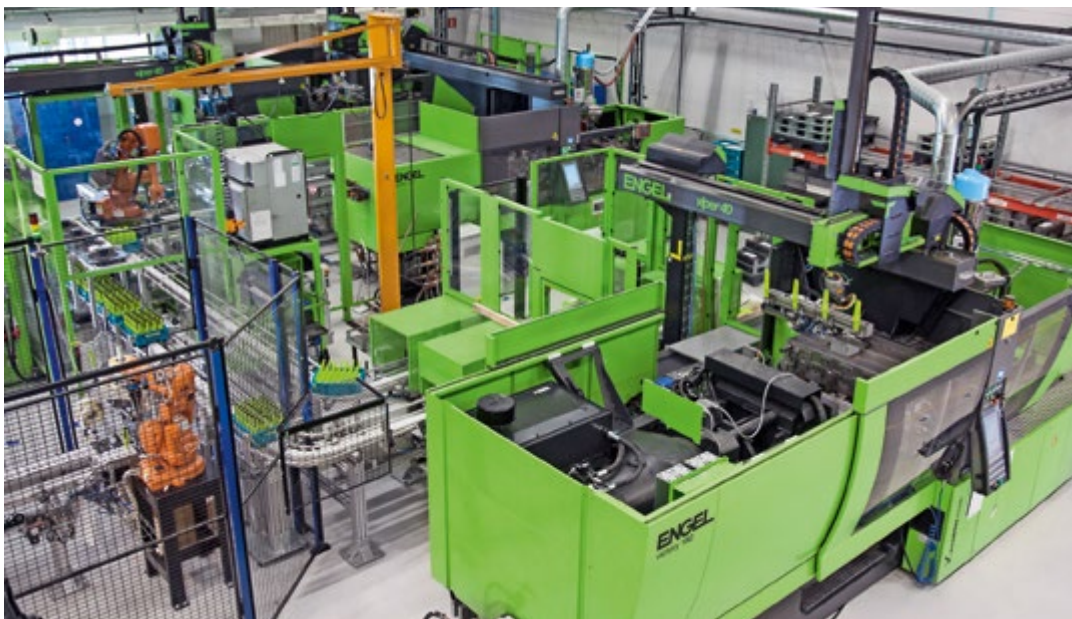
Gabriel, so nennen die Mitarbeiter von Morakniv die hochintegrierte und vollständig automatisierte Fertigungszelle. Pro Stunde liefert sie 480 Outdoormesser. Foto: Engel
